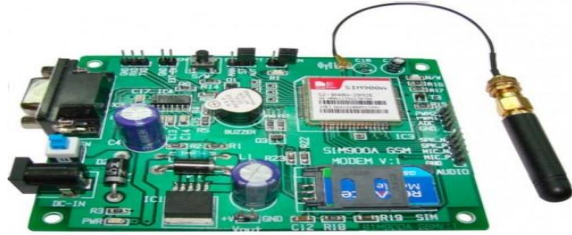
Fig: 4 GPRS Module
